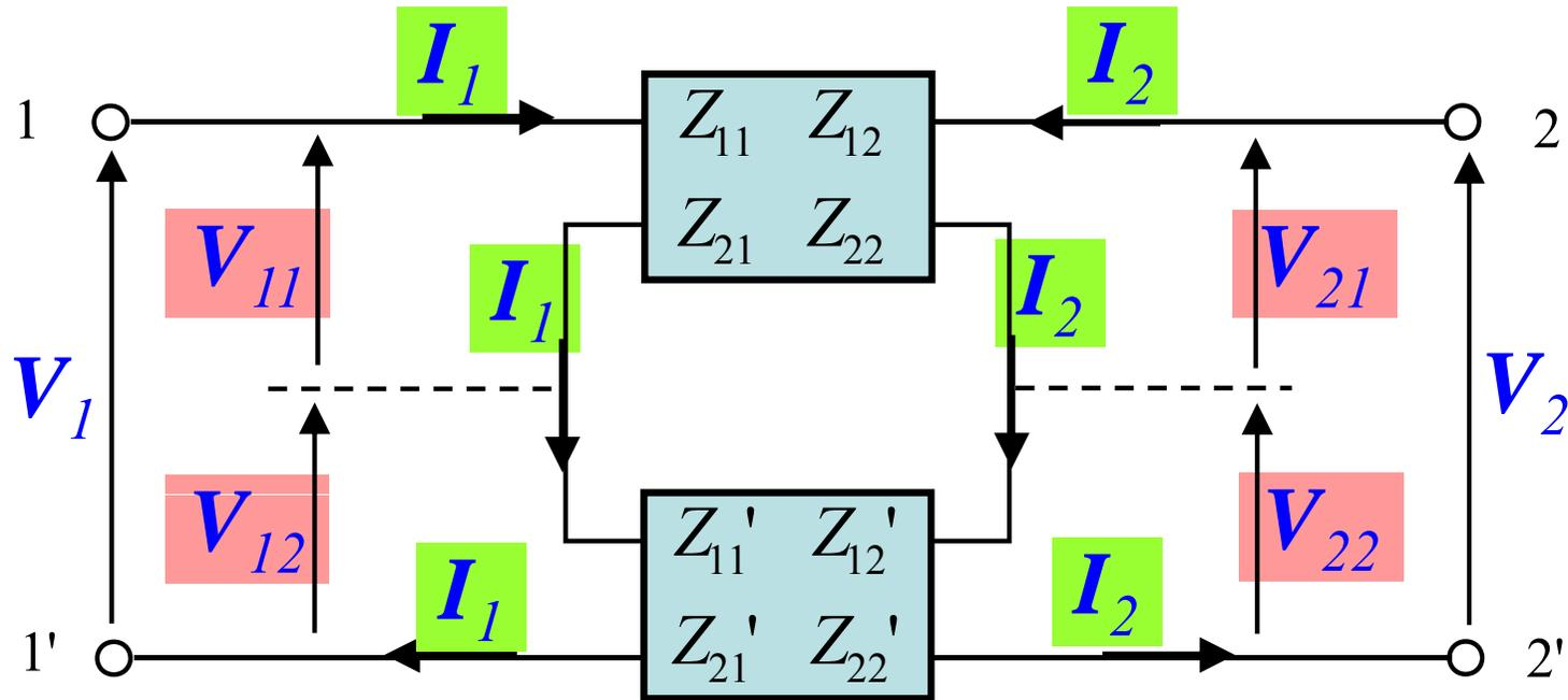
$$\begin{bmatrix} V_1 \\ V_2 \end{bmatrix} = \begin{bmatrix} V_{11} \\ V_{21} \end{bmatrix} + \begin{bmatrix} V_{12} \\ V_{22} \end{bmatrix} = \begin{bmatrix} Z_{11} + Z'_{11} & Z_{12} + Z'_{12} \\ Z_{21} + Z'_{21} & Z_{22} + Z'_{22} \end{bmatrix} \begin{bmatrix} I_1 \\ I_2 \end{bmatrix}$$
