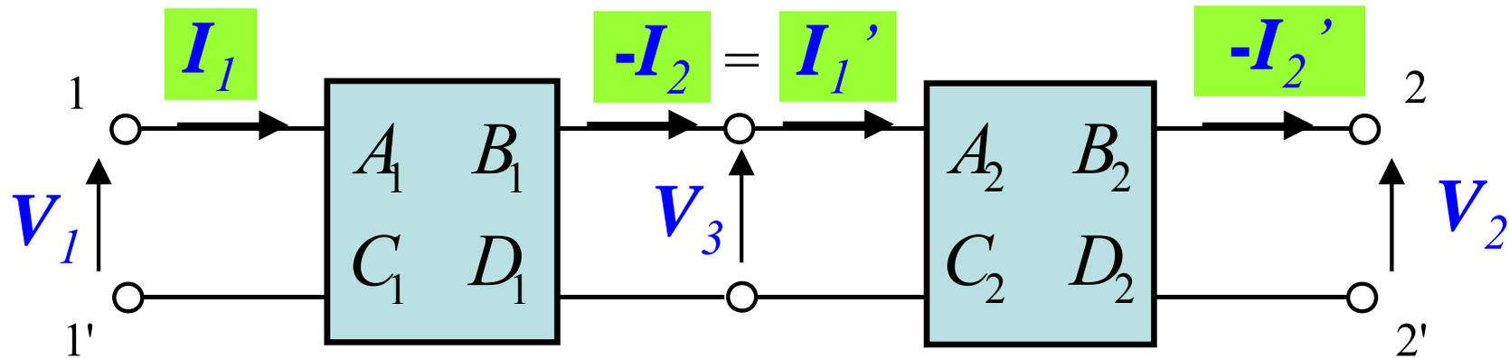
$$\begin{bmatrix} V_1 \\ I_1 \end{bmatrix} = \begin{bmatrix} A_1 & B_1 \\ C_1 & D_1 \end{bmatrix} \begin{bmatrix} V_3 \\ -I_2 \end{bmatrix} = \begin{bmatrix} A_1 & B_1 \\ C_1 & D_1 \end{bmatrix} \begin{bmatrix} A_2 & B_2 \\ C_2 & D_2 \end{bmatrix} \begin{bmatrix} V_2 \\ -I_2' \end{bmatrix}$$
