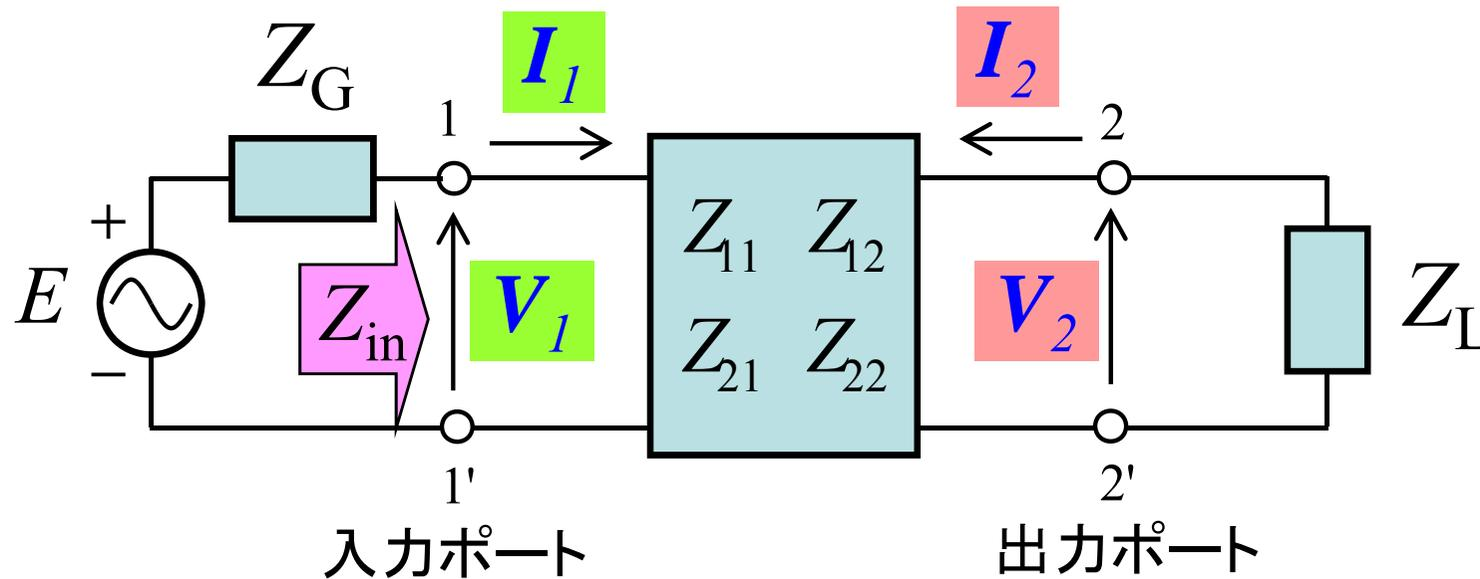
ポート1に、内部インピーダンス $Z_G$ を有する電圧源 $E$ を接続し、
