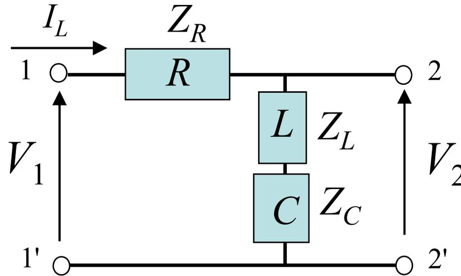
$$V_2 = I_L (Z_L + Z_C) = \frac{V_1}{Z_R + Z_L + Z_C} (Z_L + Z_C)$$
